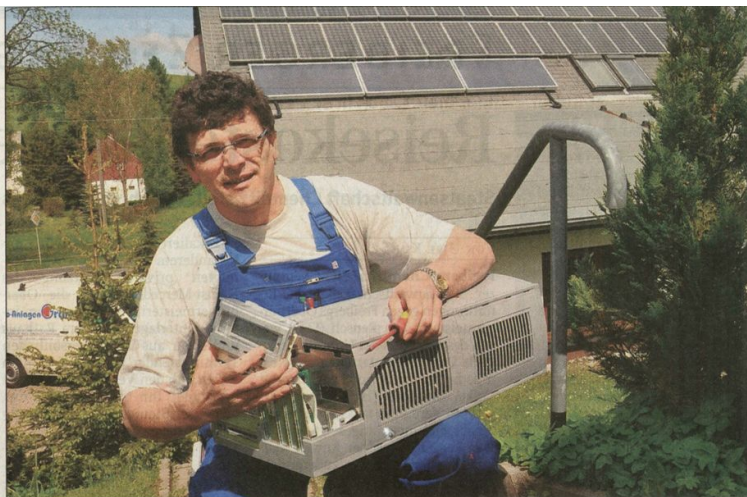
Steffen Grän aus Ullersdorf bei Sayda erhielt den Umweltpreis. Hier zeigt er einen Wechselrichter, der Gleichstrom aus seinen Photovoltaikmodulen in Wechselstrom umwandelt.
